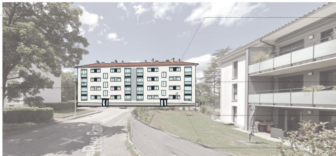
*Conserver les meneaux existants en retrait par le choix d'un isolant à l'épaisseur adaptée et traitement spécifique de l'ensemble (encadrement et meneaux en habillage métallique ou mis en peinture et coffres de volets roulants visibles et métalliques)*
